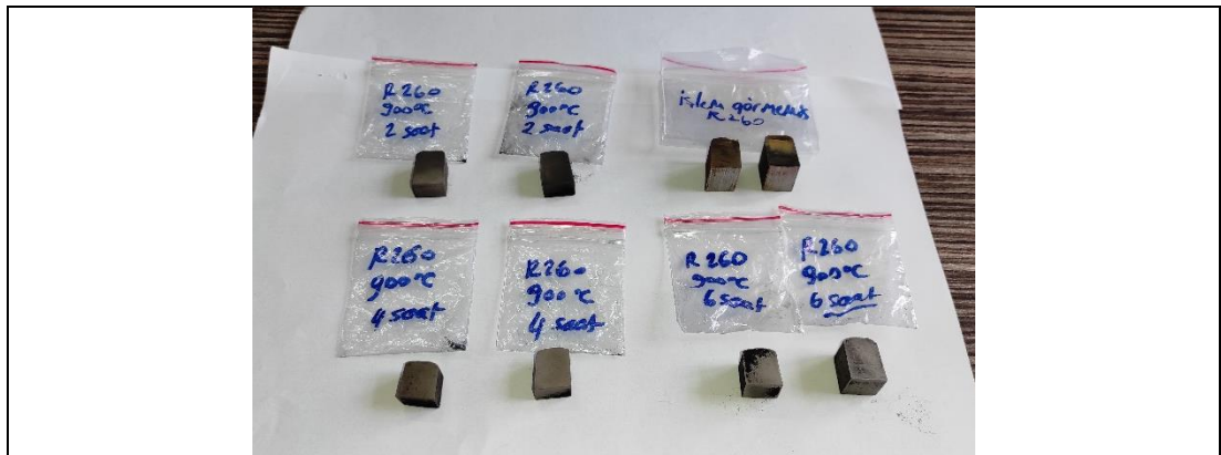
Şekil 19: Borlama işlemi sonrasında elde edilen numunelerden bazıları
