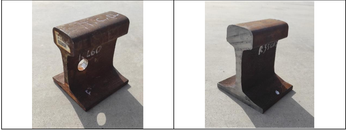
Şekil 11: Çalışmada kullanılan raylar (R260 ve R350HT)
