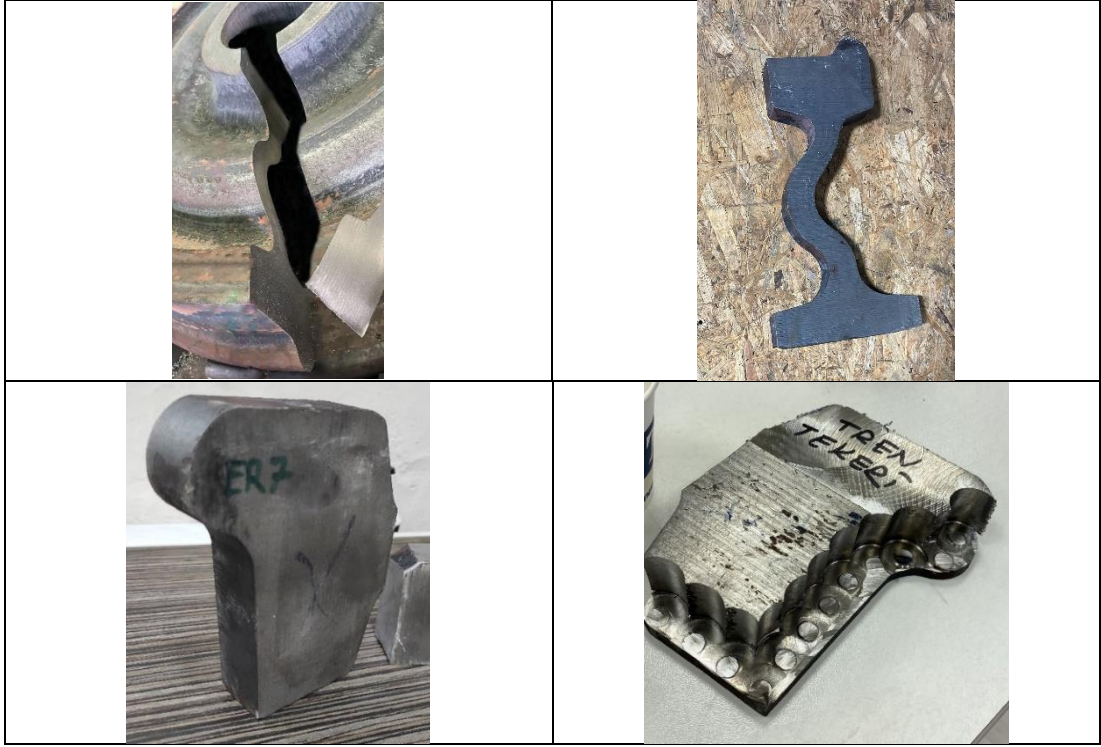
Şekil 16: Aşınma deneyinde kullanılan tren tekeri malzemesi
