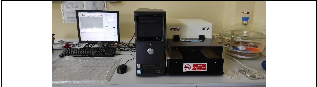
Şekil 22: Aşınma alanlarının incelenmesinde kullanılan profilometre
