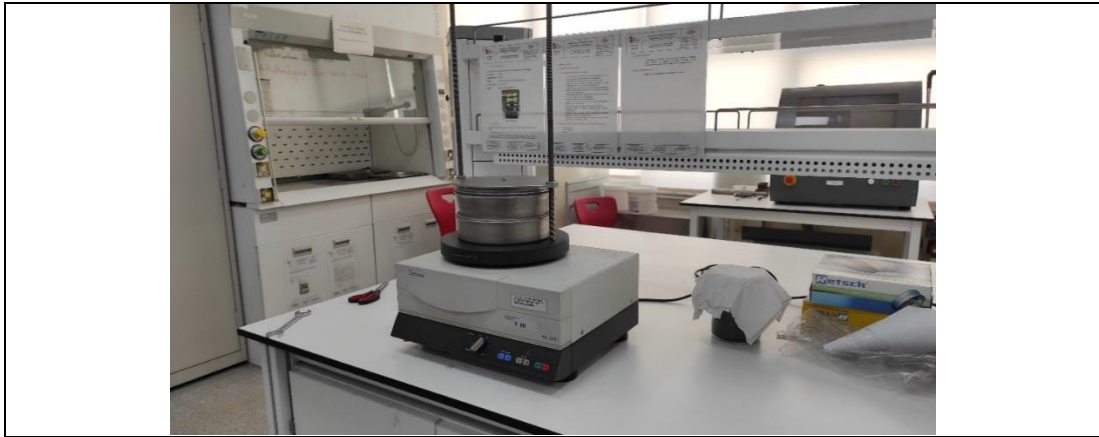
Şekil 15: Bor tozlarının 75 µm'nun altına eleme işlemi
