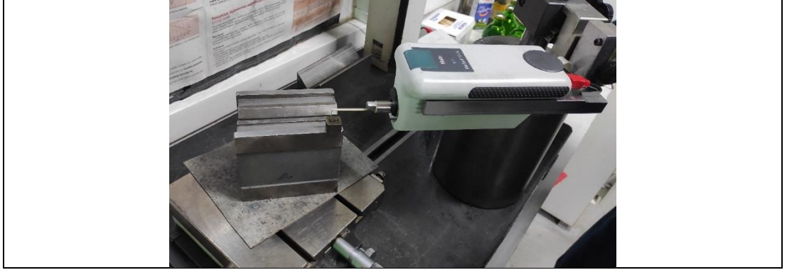
Şekil 27: Yüzey pürüzlülüğünün ölçüldüğü cihaz
